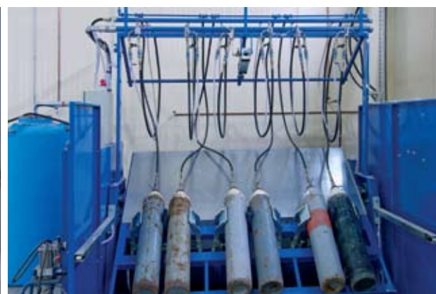
Makina per kontroll hidraulik me 6 poste per bombelat e ajrit dhe zjarrfikesit. - Presioni maksimal per kontroll 450 bar - Kontrollon maksimum 30 bombela ne ore.
