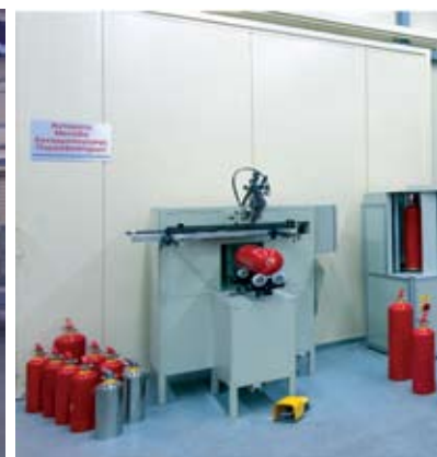
Makine per etiketa. Mund te tiposi udhezime perdorimi dhe mirembajtese ne zjarrfikes.
