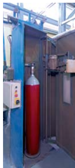
Makine per pastrimin e jashtem dhe lysterjen e bombelave te ajrit dhe zjarrfikesave.
