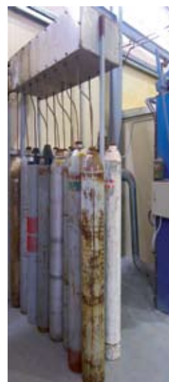
Repart per tharjen e bombelave dhe zjarrfikesave qe kalojne nga makina e kontrollit hidraulik.
