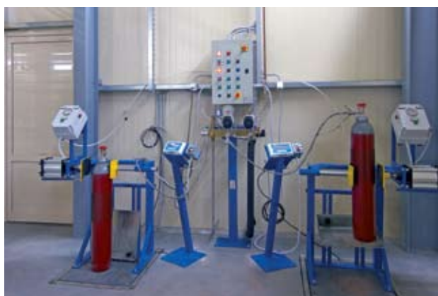
Reparti per mbushjen e dioksidit te karbonit me kater poste per mbushje.
