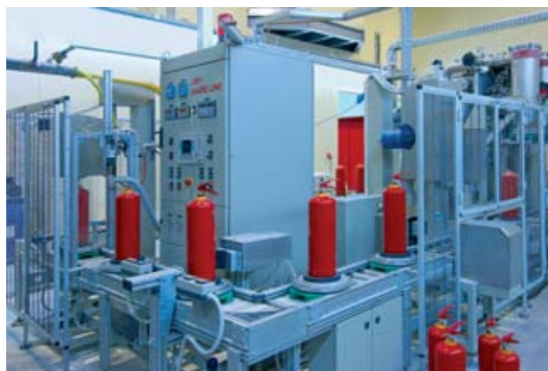
Stade te procesit te riparimit: -Mbushje automatike me pluhur -Tundje gjate mbushjes -Vidhosjen e mekanizmit -Mbushjen me ajrin pronovues (perzierje Azot - Ilion).
