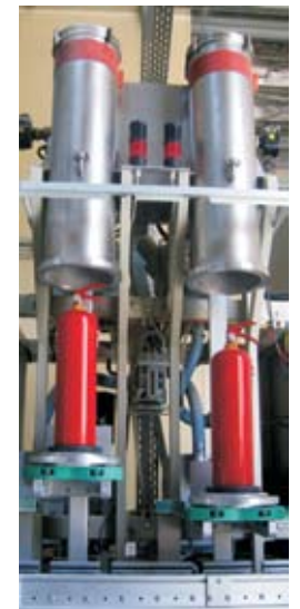
Makina per kontrollin e rrjedhjes se ajrit pronovues (perzierje Azoti -Ilion) me kontrollues te ndjeshem per Ilion ne baze te standarteve European.
