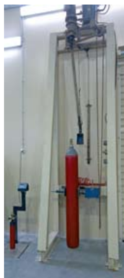
Makine per vidhosje - cvidhosjen e mekanizmave te bombelave te ajrit dhe zjarrfikesave.
